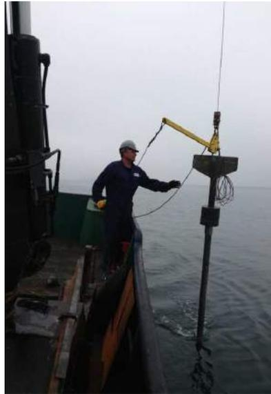
Muestreo de sedimentos *Piston Corer*.
