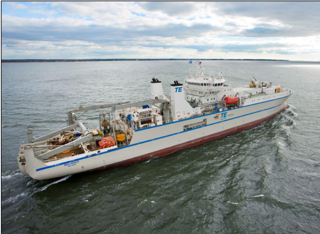
Buque cablero RESPONDER de 145 m de eslora, que transporta los equipos y personal para la reconstrucción de la estación de vigilancia hidroacústica.
